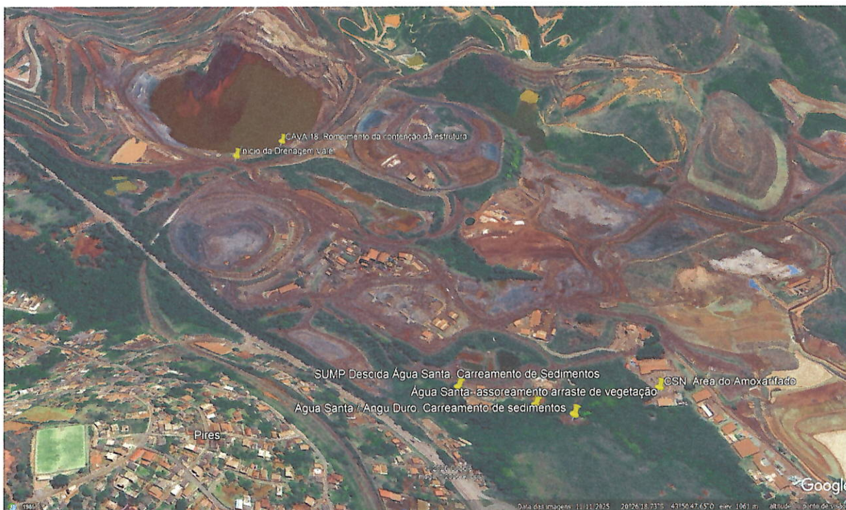
Imagem 01 – Vista da Cava 18 na área da empresa Vale e das áreas afetadas na área devido o rompimento da leira de contenção. Imagem Google Earth. Acesso em 29/01/2026.
